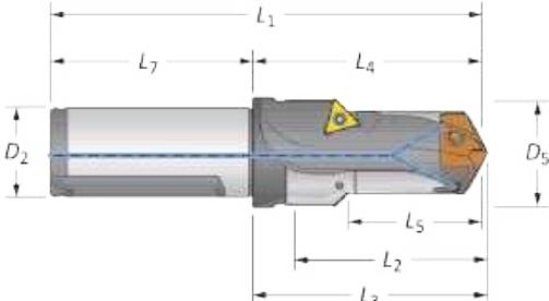
**Drill / Chamfer**
