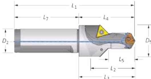
**Drill / Chamfer**
