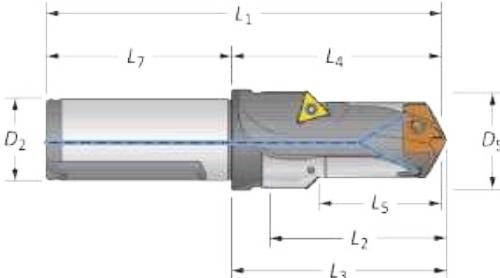
**Drill / Chamfer**
